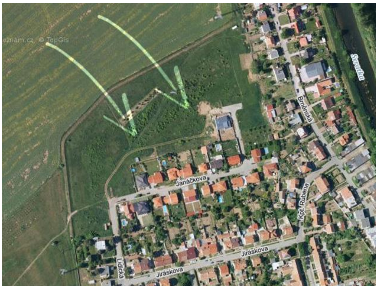
Obr. 8: Předpokládaný směr proudění podzemních vod
