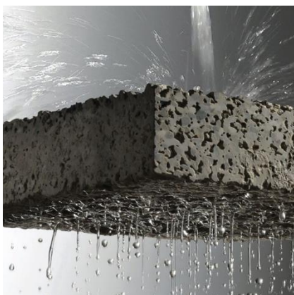
Obr. 49: Drenážní / porézní beton
